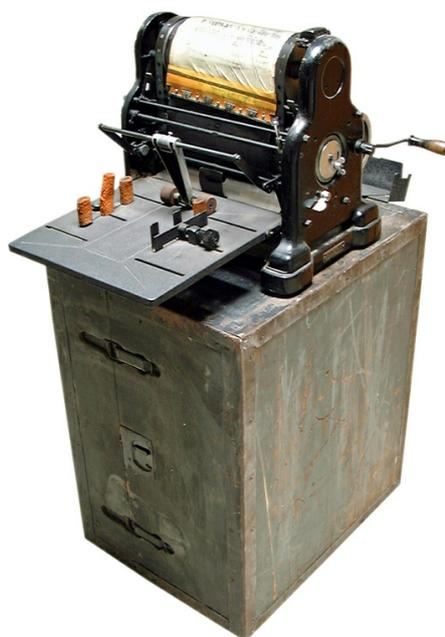
Actionné par une manivelle, le duplicateur comprend un rouleau sur lequel se fixe le stencil, un plateau pour le papier vierge et un autre pour la réception des feuilles imprimées. Il est muni d'un mécanisme d'introduction des feuilles et d'une pompe à encre. Un compteur mécanique calcule le nombre de pages imprimées.
